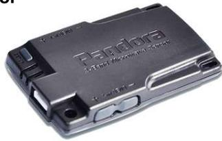
Der Mikrowellensensor ist ein Bewegungsmelder. Der Sensor erkennt Bewegungen im Fahrzeuginnenraum bzw., wenn sich jemand außerhalb vor den Fensterscheiben bewegt. Die Reichweite bzw. die Empfindlichkeit lässt sich stufenlos über zwei Einstellregler am Sensor justieren. Beide Zonen lassen sich getrennt einstellen. Nach Anlegen der Betriebsspannung beginnt für 10 Sekunden die Autokalibrierung, bei dem der überwachte Bereich abgemessen wird.
